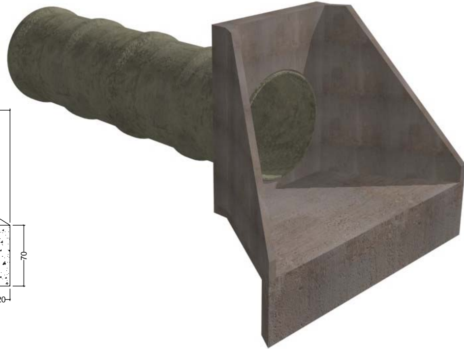
ALA DE REDE TUBULAR - DIMENSIONAMENTO
