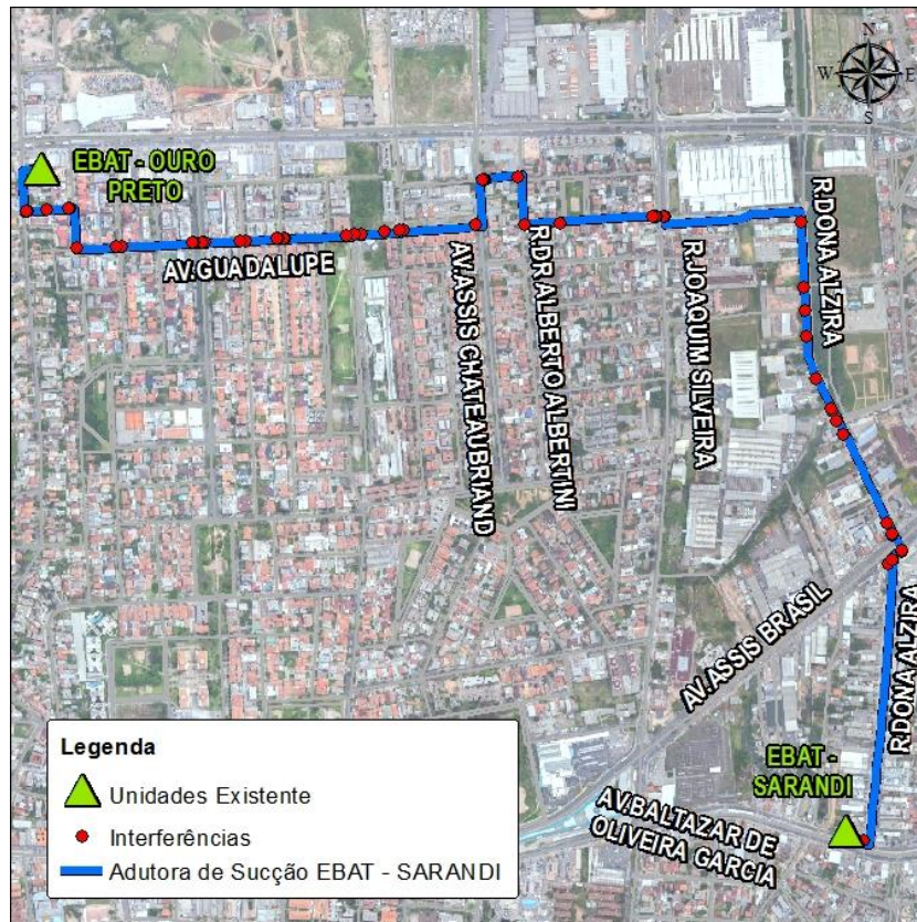
Figura 2.4 – Interferências existentes no traçado da Alternativa
