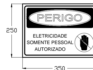
DETALHE DA PLACA DE ADVERTÊNCIA SEM ESCALA
