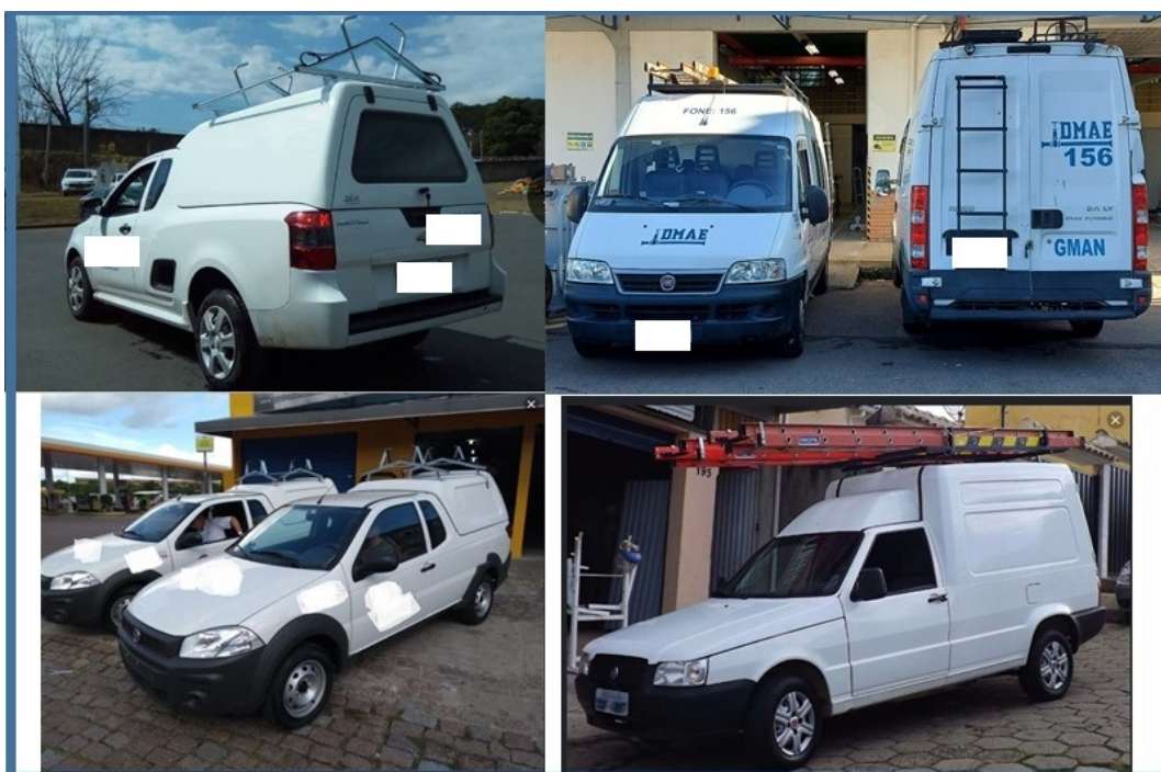
Figura 1: exemplos de veículos para equipe elétrica. Compartimentos de carga fechados e separados do compartimento de passageiros, rack para 2 escadas, capacidade para, pelo menos, 2 passageiros.
