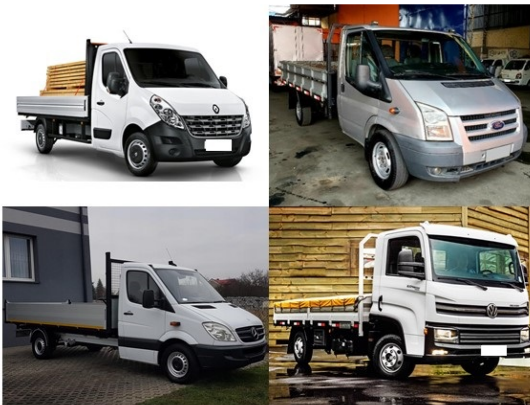
Figura 2: Exemplos de veículos para equipe mecânica. Caminhão com caçamba aberta, espaço para 3 passageiros em compartimento independente do compartimento de carga.
