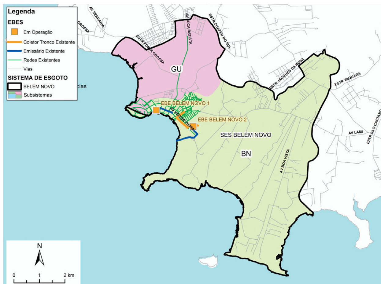
Figura 5.19: Situação atual do esgotamento sanitário no SES Belém Novo.
