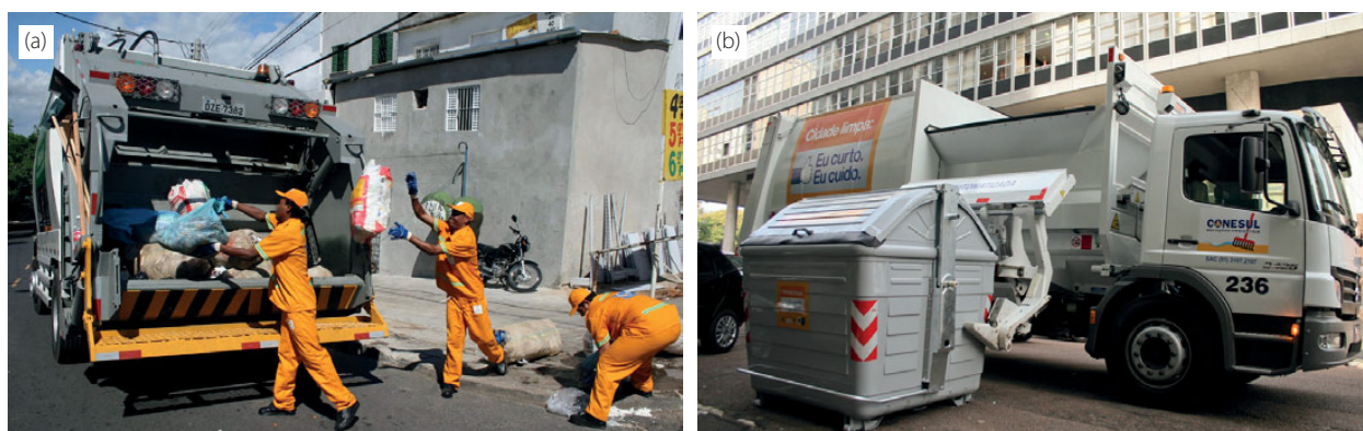
Figura 7.9: Coletas domiciliares (a) convencional junto ao meio-fio e (b) automatizada.
