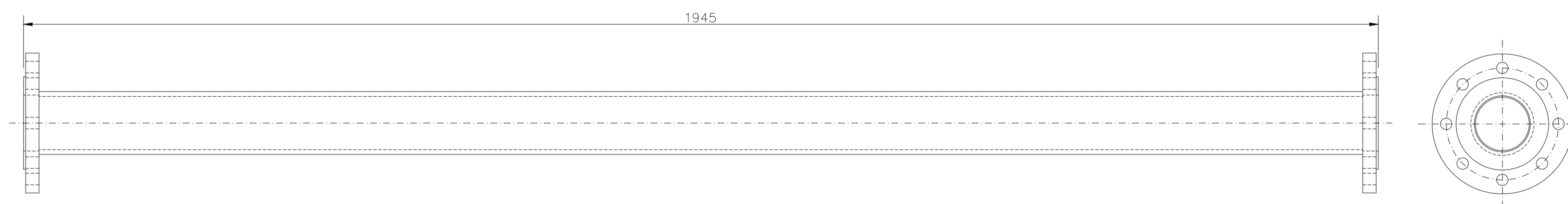
PEÇA 6 - ESCALA 1:5 TUBO PEAD DN90 SDR 13.6 PN-10 COM FLANGE E COLARINHO DN80 PN-10 ABNT NBR 7675
