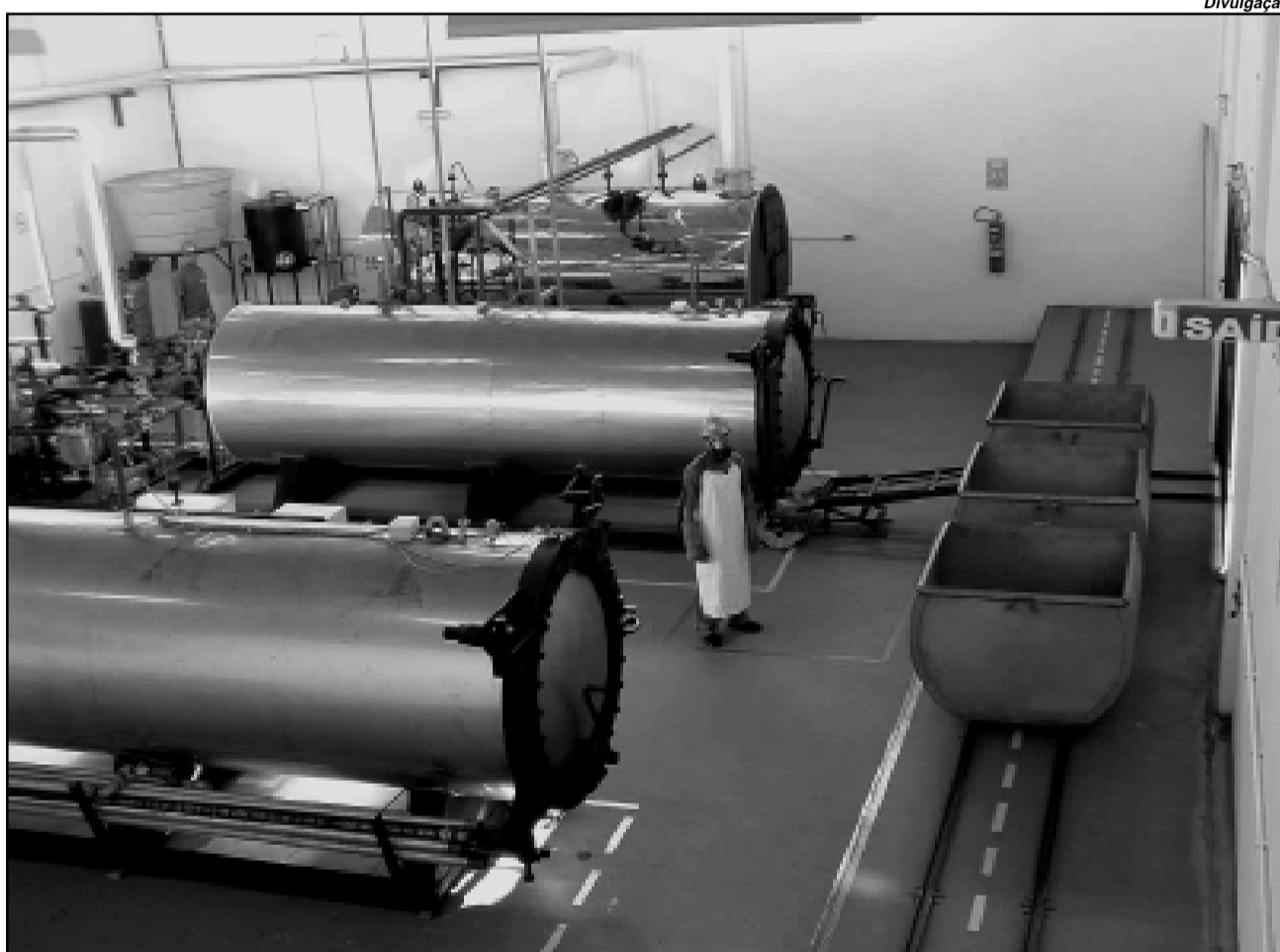
Autoclave: Porto Alegre será a primeira capital brasileira a adequar-se às normas da Agência Nacional de Vigilância Sanitária para tratamento do lixo hospitalar
