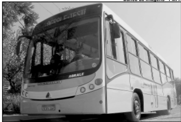
Ônibus testado possui piso baixo e rampa para Pessoas Portadoras de Deficiência
