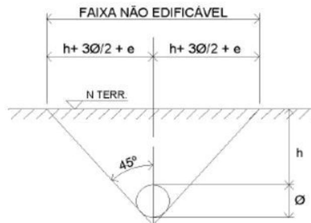
Figura 4.2 – Faixa não-edificável gerada por canalizações pluviais de seção circular.
