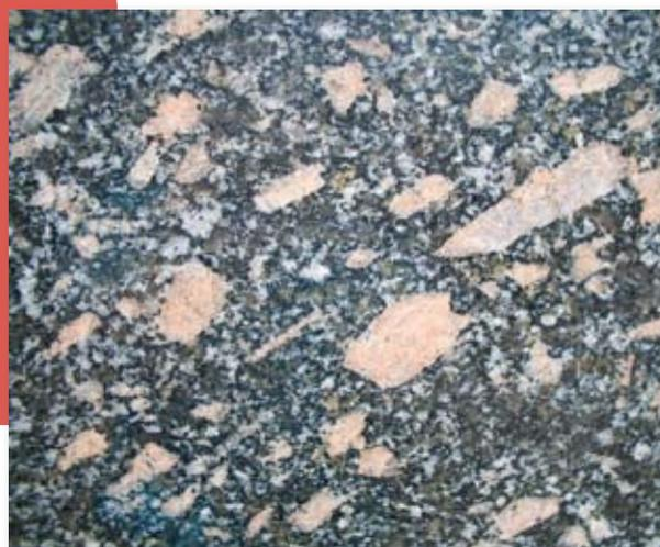
Nestes locais, o granito mostra estrutura foliada com porfiroclastos estirados de K-feldspato com forma de Augen, envolvidos por uma matriz média a fina com forte orientação de biotita e estiramento de quartzo de cor escura. Estas zonas mostram direção nordeste e apresentam-se paralelas a subparalelas à orientação de fluxo marcada pelo alinhamento dos megacristais e enclaves máficos.
