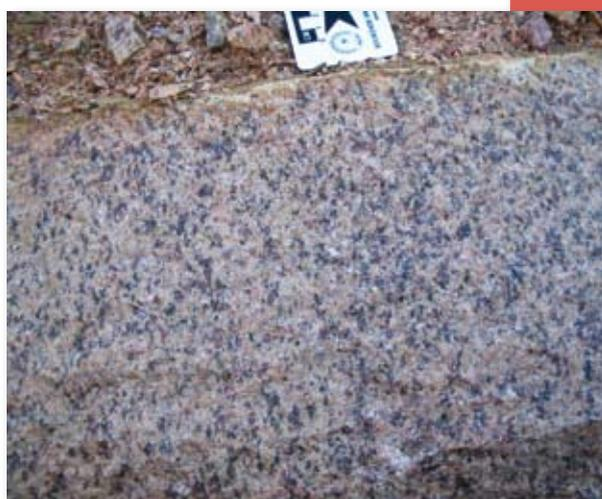
**Aspecto macroscópico do Granito Santana na antiga pedreira da Construtora Zocoloto, com destaque para textura equigranular média e foliação magmática com disposição aproximadamente subvertical definida pelo alongamento do quartzo.**
